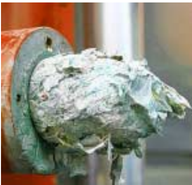
Abgewaschene Etiketten werden gepresst und kommen aus der Röhre.
